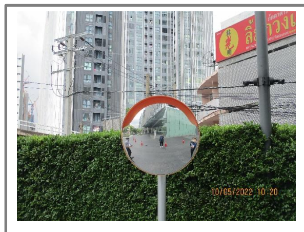
รูปที่ 3.1-60 ติดตั้งกระจกโค้งบริเวณจุดอับสายตา
